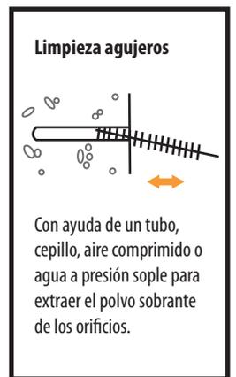
Instale los pernos con el taco químico siguiendo las instrucciones del fabricante, se recomienda **HILTI HIT-1/ HIT-1 CE** inyección mortero o similar.
