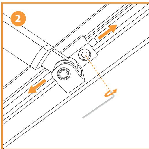
Es posible modificar la posición de los brazos a lo largo del perfil delantero. Para ello deberá aflojar los tornillos del soporte del disco de regulación. Con ayuda de un nivel asegúrese de que se encuentra paralelo al suelo.
