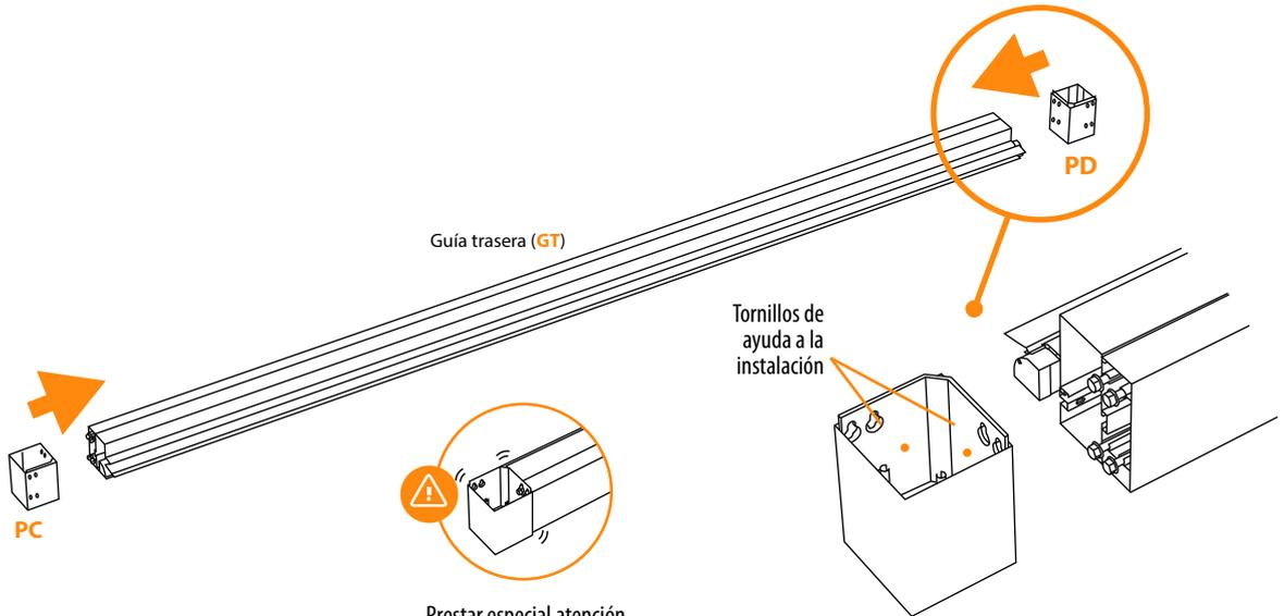
Prestar especial atención al anclaje entre pilares y guías, al no estar fijado totalmente podría soltarse y causar un accidente.
