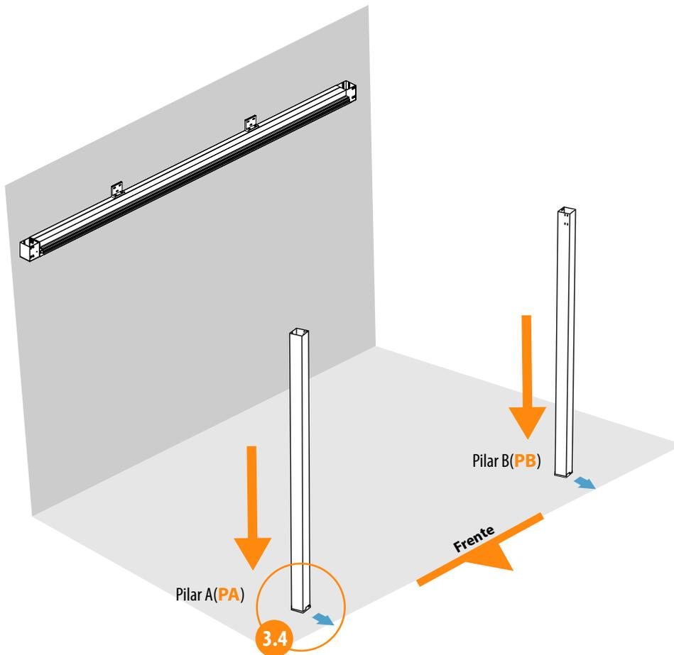
3.2 Insertar el pilar en el soporte suelo y apretar los 4 tornillos con ayuda de una llave allen.
