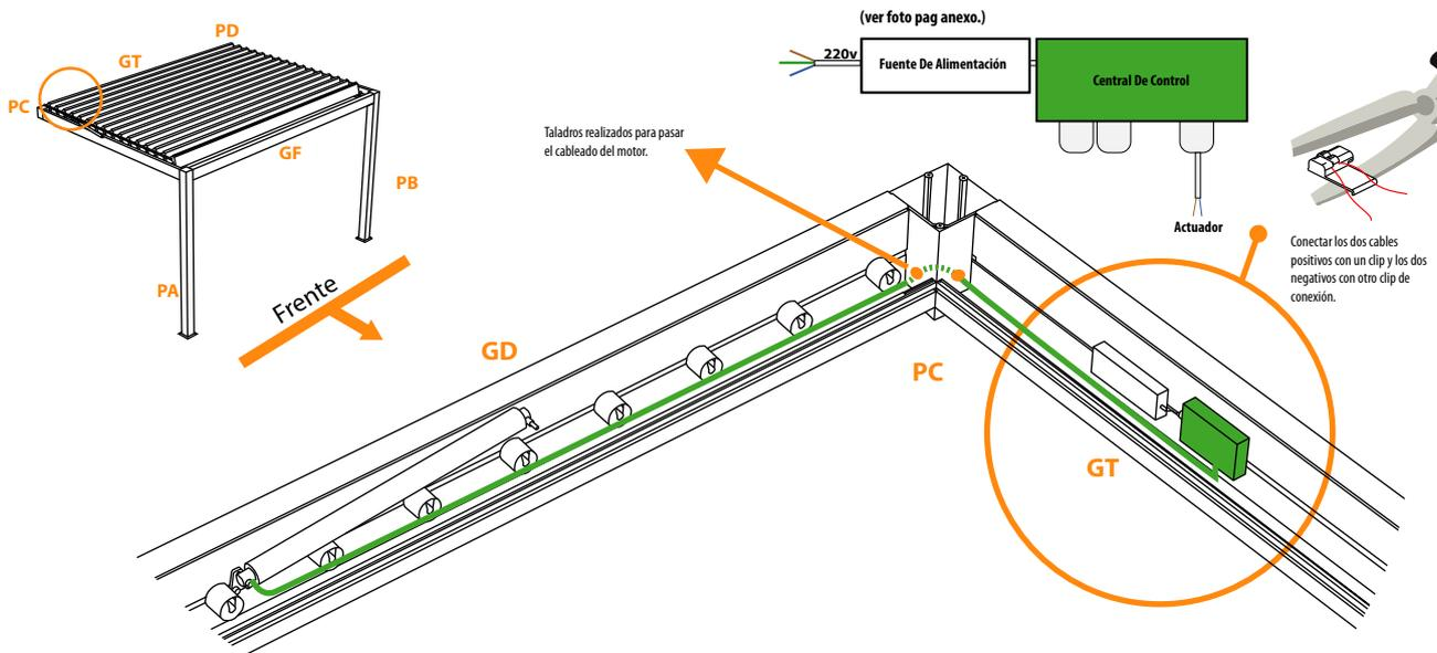
**6.3** **Conexión eléctrica** Para pasar el cable de corriente se taladra manualmente en la zona deseada, según donde esté localizada la toma de corriente.
