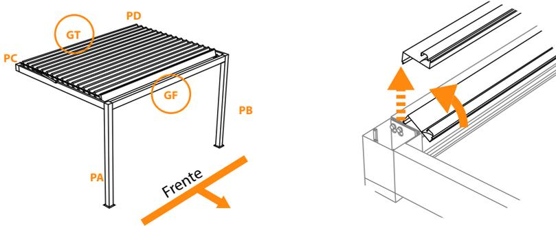
**6.2** **Conexión del motor.** La caja de control se encuentra instalada en la guía trasera (GT), junto a la fuente de alimentación, deberá pasar el cable desde el pistón a través de la canaleta, en los pilares a través de los taladros que se realicen para este fin, conectar el terminal a la caja de control en la correspondiente ranura.
