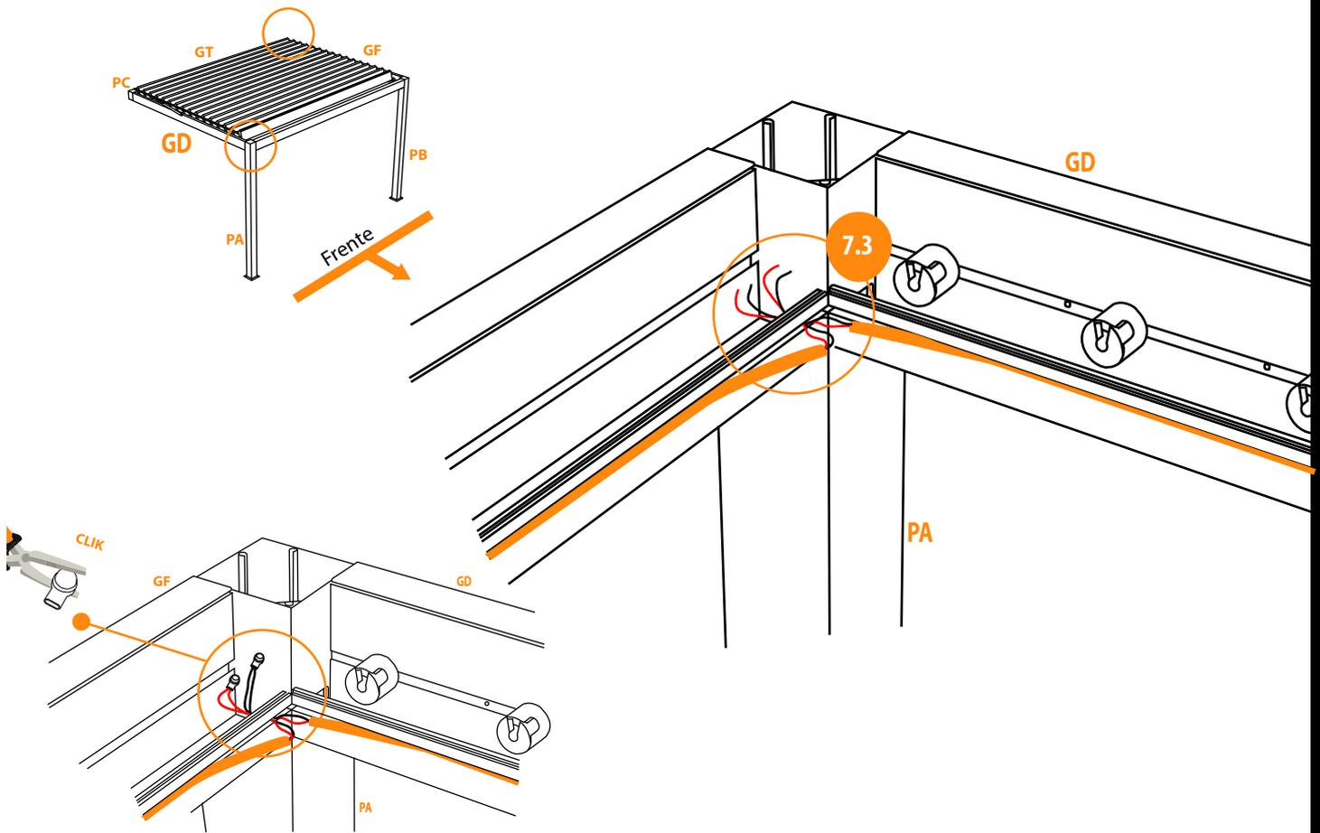
**7.4 Conexión LED a central de control:** Una vez hallamos realizado los pasos anteriores procederemos a la conexión con la central de control, situada en la guía trasera GT.
