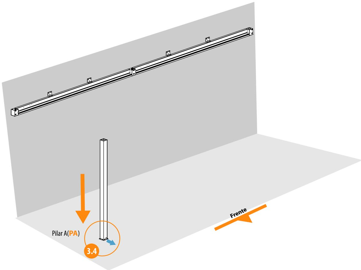
3.4 Atornillar el soporte suelo a la base de pernos sin llegar a una fijación completa, posteriormente necesitaremos reajustar la posición de pilares por lo que estos aun no deben estar totalmente fijados, atornillaremos lo necesario para realizar el montaje con seguridad.
