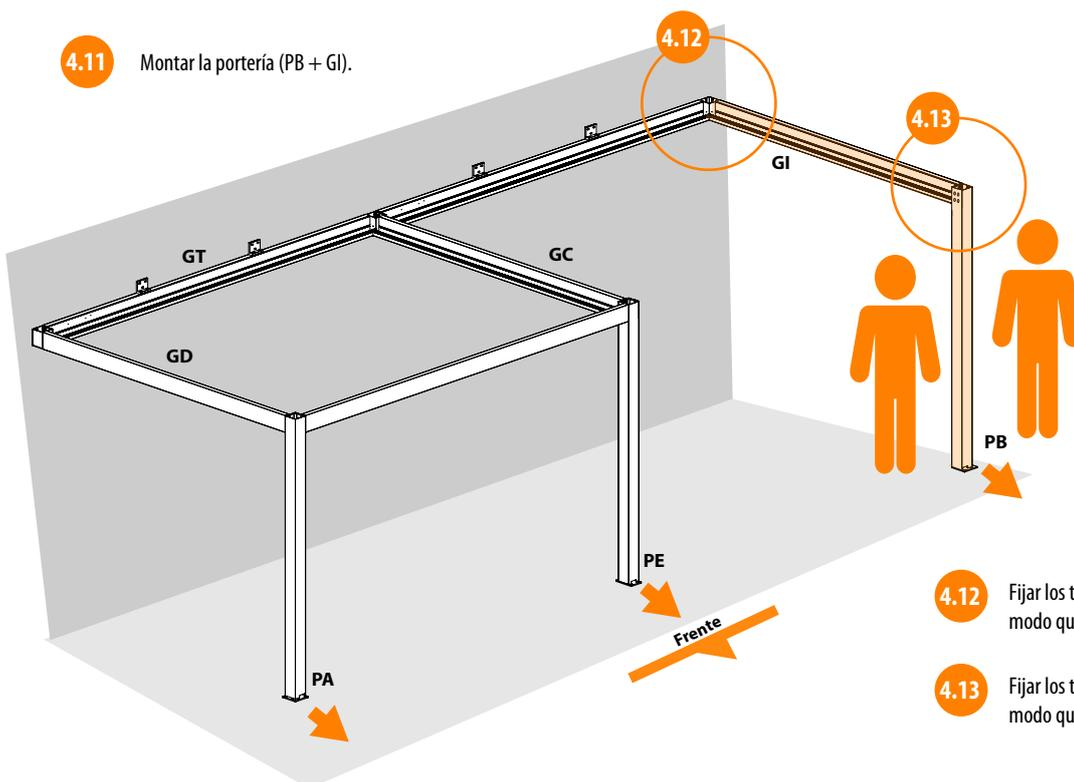
**4.12** Fijar los tornillos de la estructura de igual modo que el punto 4.3
