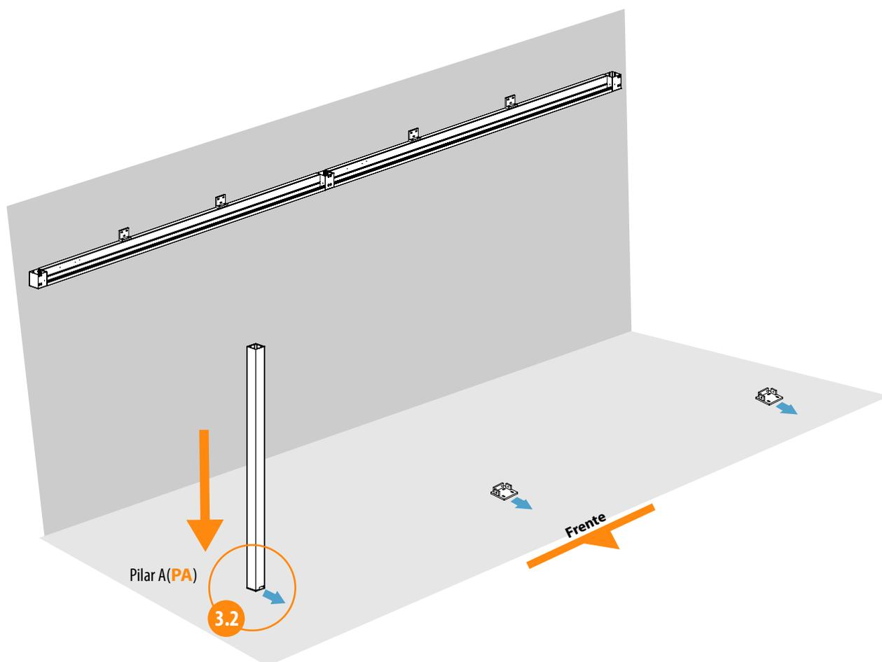
**3.4** Insertar el pilar en el soporte suelo y apretar los 4 tornillos con ayuda de una llave allen. Continúe con los pasos del punto 4 de este manual. (pg.12)
