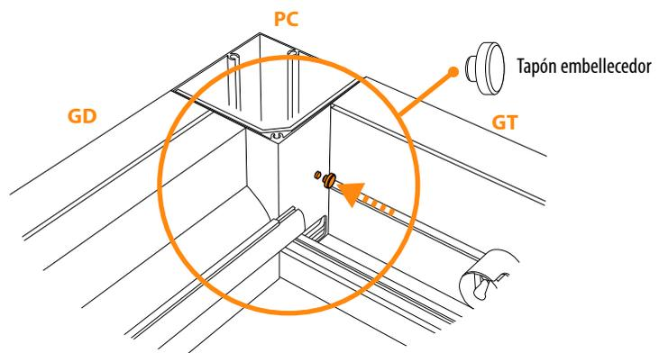
Con ayuda de una llave procederemos a fijar fuertemente la tornillería de anclaje entre las guías y los pilares.
