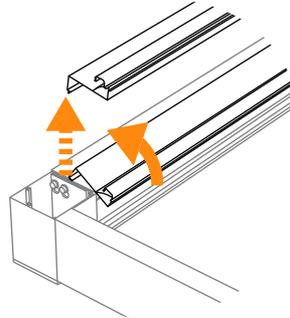
**5.2** **Conexión del motor.** La caja de control se encuentra instalada en la guía trasera (GT), junto a la fuente de alimentación, deberá pasar el cable desde el pistón a través de la canaleta, en los pilares a través de los taladros que se realicen para este fin, conectar el terminal a la caja de control en la correspondiente ranura.
